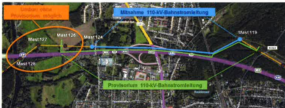
Abbildung 4: Verlauf Provisorium entlang der BAB 10
